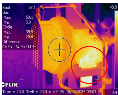
Fig. 3.3 Analiza termografică unitate de comprimare
