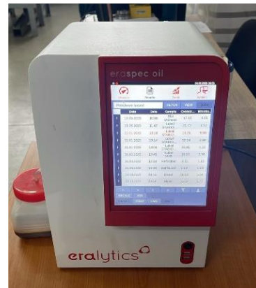
Fig. 2.4 Analiza lubrifianților. Echipament portabil pentru analiză ulei
