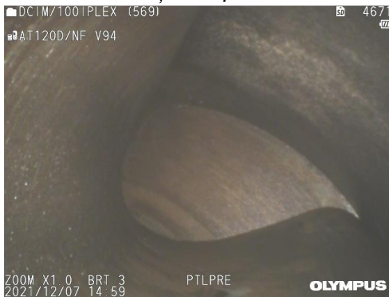
Fig. 2.3 Analiza prin boroscopare. Vizualizare interioară stare roți melcați
