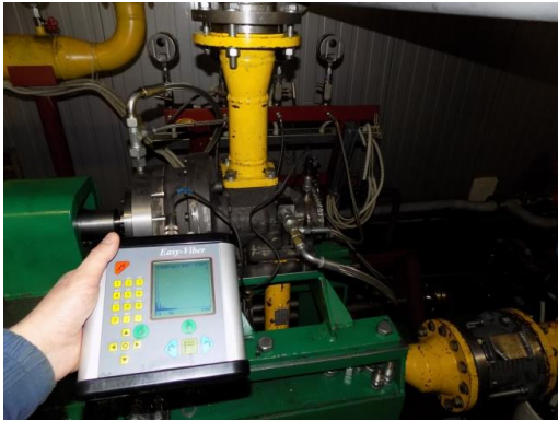
Fig. 2.1 Analiza nivelului de vibrații. Analizor vibrații Viber X1- măsurat nivel vibrații compresor
